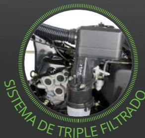
Sistema de triple filtrado, que incluye filtro de aire en baño de aceite y filtro de snorkel de doble protección.
